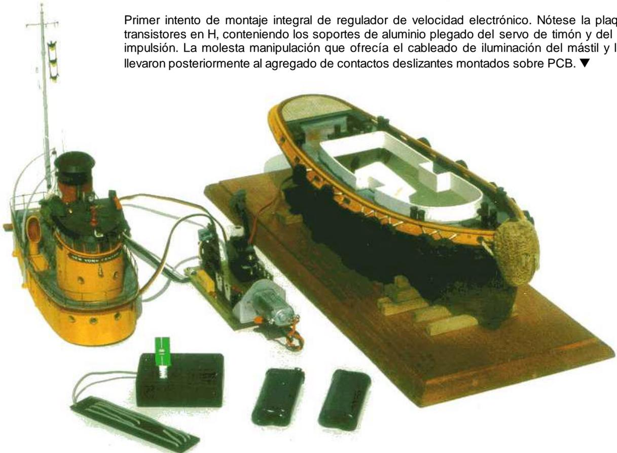
Primer intento de montaje integral de regulador de velocidad electrónico. Nótese la plaqueta con transistores en H, conteniendo los soportes de aluminio plegado del servo de timón y del motor de impulsión. La molesta manipulación que ofrecía el cableado de iluminación del mástil y la cabina, llevaron posteriormente al agregado de contactos deslizantes montados sobre PCB. ▼
