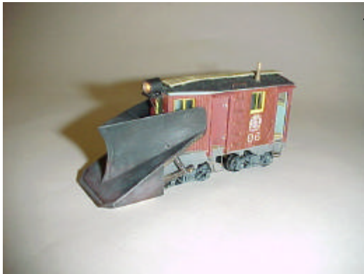
◀ Pala barrenieves D&RGW H0n3 (Trocha angosta), totalmente scratchbuild
