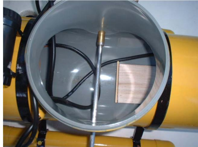
Vista superior sin la tapa roscada, desde este ángulo se ve la base que soporta la batería y el eje que une los dos motores.
