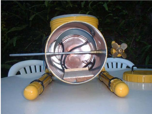
Vista de popa sin la tapa, vemos el eje que une los motores y la base de la batería
